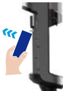
7. Mettez des gants en caoutchouc et retirez la batterie.
