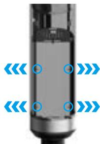
5. Retirez ces quatre vis à l'aide d'un tournevis adapté.
